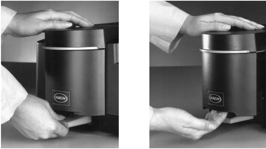
图 7 开启模块锁和取出模块
